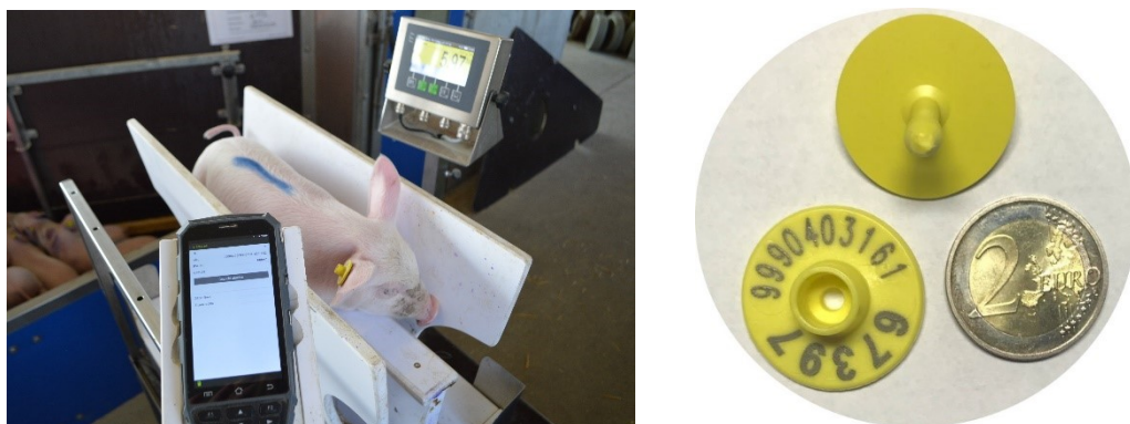
Abbildung 28: Automatisierte Erfassung von Einzeltiergewichten mit digitaler Ferkelwaage und mobilem Endgerät auf Grundlage einer UHF-RFID-Ohrmarke zur Tiererkennung und -identifikation (Keßler 2022)
