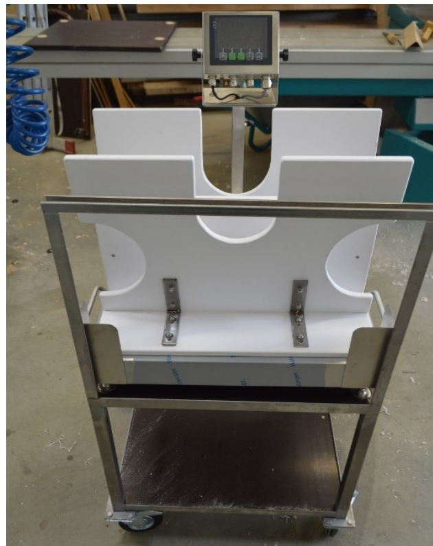
Abbildung 40: Saugferkelwaage mit mobilem Unterbau und Vorrichtung für das Wiegen der älteren Saugferkel (Keßler 2019)
